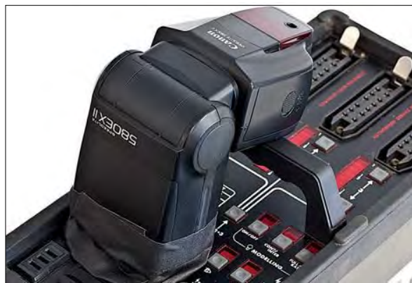
Рисунок 11.55 Небольшим количеством изоляционной ленты вы можете оградить ведомое устройство студийного пакета, так чтобы оно видело только срабатывание ведомой вспышки Speedlite в гибридном беспроводном режиме.
