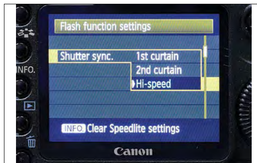
Рисунок 21.3 Установка HSS через ЖК-дисплей 5D Марк II.
