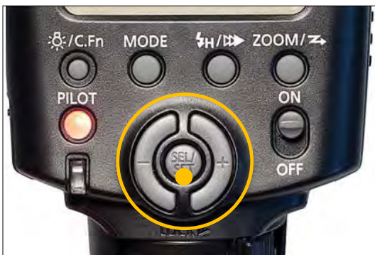
Рисунок 8.9 Нажмите кнопку Sel/Set (выбор/установка) в центре кнопок Plus/Minus (+/-). Дробь замигает (сообщая, что она может быть изменена).
