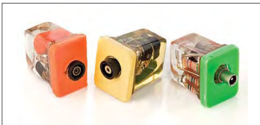
Рисунок 10.14 У оптических ведомых устройств от Sonia, совместимых со вспышками Canon EX, основа зеленая. Оранжевые и желтые ведомые устройства не будут правильно работать со вспышками Canon Speedlite.
