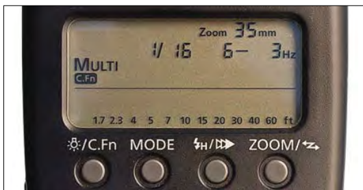
Рисунок 7.4 Режим Multi (стробоскопический). Вспышка Speedlite работает с 1/16 мощности, 6 раз, 3 срабатывания в секунду.
