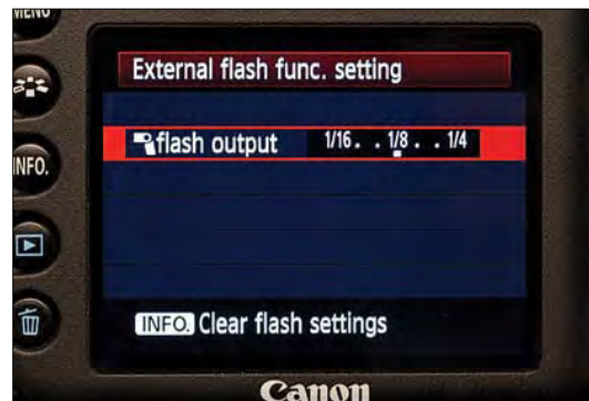
Рисунок 8.21 Вращайте диск выбора, пока не будет выбран желаемый уровень мощности. Нажмите кнопку Set (установки) для подтверждения выбора.
