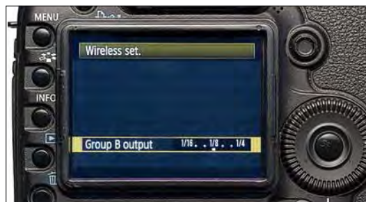
Рисунок 11.52 Шаги 11 и 12 – на рисунке уровень мощности для Group B (Группа B) установлен в 1/8.
