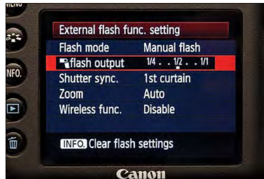
Рисунок 8.20 Вращайте диск выбора, пока не будет подсвечена строка "Flash output" (Мощность вспышки). Нажмите кнопку Set (установки) для подтверждения выбора.
