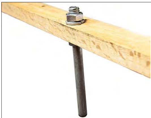
Рисунок 23.5 Мои самодельные дубовые рейки снабжены шестигранными болтами \frac{5}{8} ". Я сверлю установочное отверстие размером \frac{9}{16} ", добавляю несколько капель клея Gorilla Glue на резьбу болта, а когда клей высыхает, отпиливаю шестигранную головку и затем закругляю конец с помощью электроточила.
