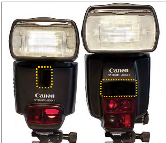
Рисунок 11.8 Датчик беспроводного управления скрыт за небольшой черной панелью, расположенной над красной панелью излучателя подсветки для автофокусировки и выделенной здесь контуром из желтых точек: вспышка 430EX II – слева, а 580EX II – справа.
