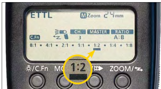
Рисунок 11.21 ЖК-дисплей вспышки 580EX II отображает отношение 1:2.
