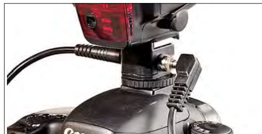
Рисунок 10.12 Крупный план адаптера горячего башмака на фотокамере с синхро-кабелями, подсоединенными с каждой стороны.
