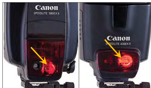
Рисунок 11.14 Красная панель излучателя подсветки для автофокусировки на 580EX II (слева) и 430EX II (справа) мигает, указывая, что вспышка Speedlite находится в ведомом режиме.
