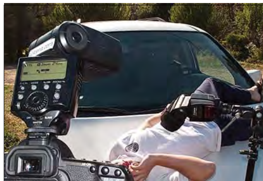
Рисунок 7.22 При съемке с беспроводным управлением, если ведущая вспышка Speedlite не участвует в освещении, я поворачиваю ее к ведомой вспышке (-кам). См. Главу 11, Беспроводный спидлайтинг, технология Canon, с описанием всех подробностей.
