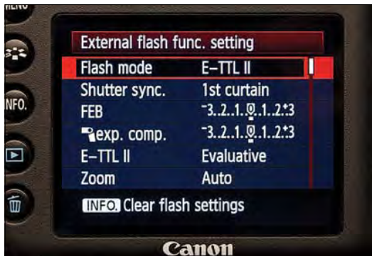
Рисунок 8.17 Этот экран показывает текущую конфигурацию вспышки Speedlite. Для изменения режима с E-TTL на Manual (ручной) нажмите на камере кнопку Set (установки), чтобы выбрать меню "Flash mode" (Режим вспышки).
