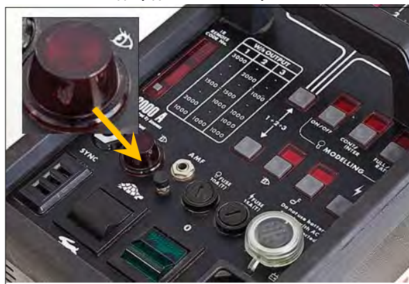
Рисунок 11.54 Оптическое ведомое устройство студийного пакета (показанное выше) будет введено в заблуждение срабатыванием предварительной вспышки в режиме E-TTL.
