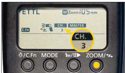
Рисунок 11.15 Нажатие кнопки Zoom циклически сменяет параметры беспроводного управления. Когда замигает CH , поверните диск выбора, чтобы выбрать канал, затем нажмите на кнопку Sel / Set , чтобы подтвердить ваш выбор.
