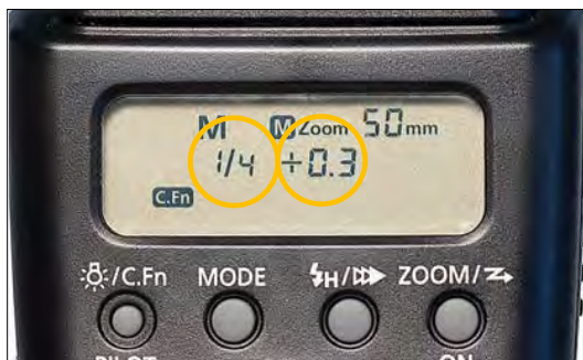
Рисунок 8.10 Нажимайте кнопки Plus/Minus , как это необходимо для изменения дроби. Она будет изменяться с шагом или в \frac{1}{2} , или в \frac{1}{3} -ступени. Здесь показано: \frac{1}{4} мощности и \frac{1}{3} ступени.
