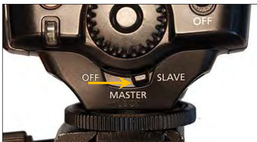
Рисунок 11.11 Внешний переключатель на вспышке Speedlite 580EX (вверху) и 430EX сразу переводит ее в ведомый режим. Просто переместите рычажок до конца вправо.
