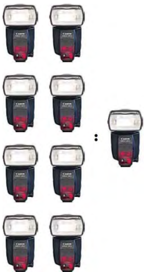
Рисунок 11.26 При отношении 8:1 левая сторона на три ступени ярче, чем правая сторона.
