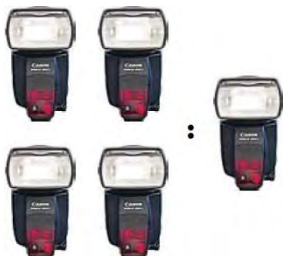
Рисунок 11.25 При отношении 4:1 левая сторона на две ступени ярче, чем правая сторона.
