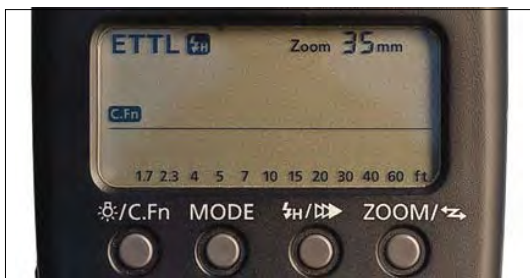
Рисунок 7.3 E-TTL режим. Фотокамера установит уровень мощности автоматически.
