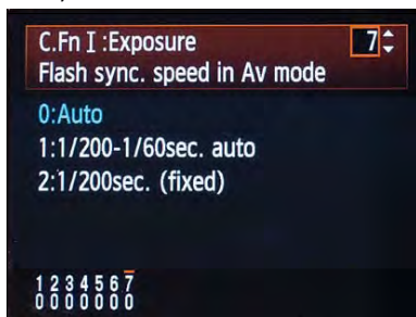
Рисунок 7.14 Меню Custom Function камеры 5D Марк II предоставляет три возможности установки скорости синхронизации вспышки с затвором в режиме приоритета диафрагмы (Av). Я предпочитаю оставлять значение параметра 0, так что моя вспышка Speedlite будет срабатывать при низких скоростях затвора. Проверьте руководство пользователя своей камеры, чтобы увидеть доступные в ней возможности.
