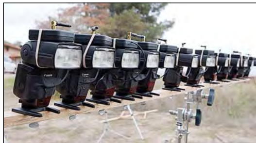
Рисунок 23.9 Самодельная рейка с 12-ю закрепленными вспышками Speedlite.
