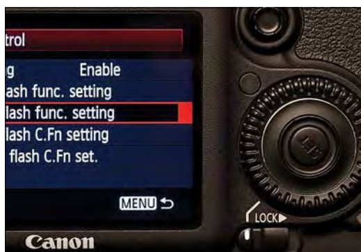
Рисунок 8.15 Используйте диск выбора, чтобы выбрать команду "External flash func. setting" (Настройки внешней вспышки).
