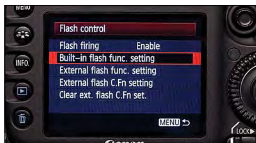
Рисунок 11.17 7D – первая камера Canon DSLR, в которой встроенная вспышка может работать ведущей вспышкой. Всеми параметрами настройки беспроводного режима встроенной вспышки управляют через ЖК-дисплей камеры. Это экран доступа к управлению встроенной вспышкой, в том числе функциями беспроводного режима.
