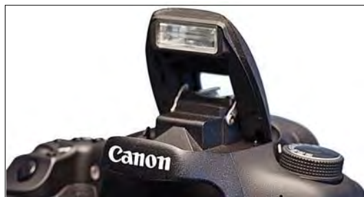
Рисунок 11.5 7D может использовать встроенную вспышку или в качестве ведущей вспышки или как вспышку Speedlite серии 500.
