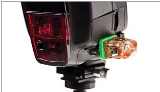
Рисунок 10.16 Вариант оптического ведомого устройства от Sonia со штырьковой частью разъема PC включается прямо в 580EX II. Для других моделей вспышки следует использовать адаптер горячего башмака.
