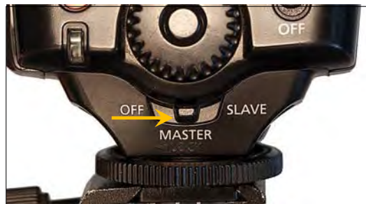
Рисунок 11.2 У вспышки 580EX есть удобный внешний переключатель, который переводит ее в беспроводный режим и обратно.
