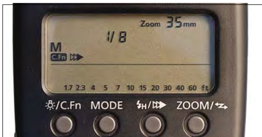
Рисунок 7.2 Ручной режим. Вспышка Speedlite работает с 1/8 полной мощности.
