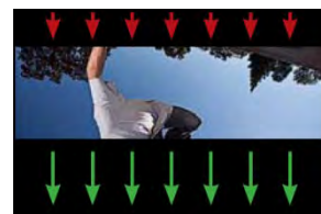
Рисунок 21.13 При скорости, превышающей скорость синхронизации, 2-я шторка начинает закрываться до того, когда 1-я шторка откроет сенсор полностью.
