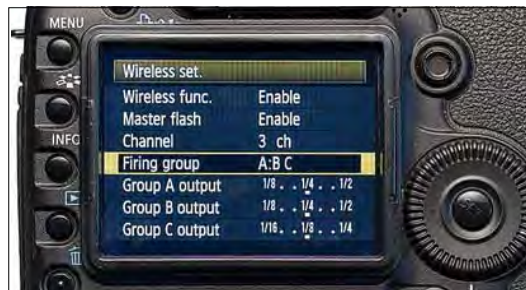
Рисунок 11.51 Шаги 11 и 12 – прокрутите вниз, чтобы установить уровень мощности для каждой группы вспышек.
