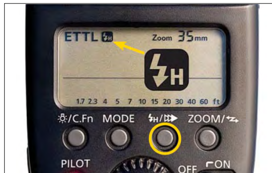
Рисунок 21.2 Активация HSS через средство ЖК-монитора вспышки Speedlite.
