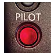
Рисунок 11.10 Нажмите кнопку Pilot на ведущей вспышке, чтобы проверить срабатывание ведомых вспышек группами
