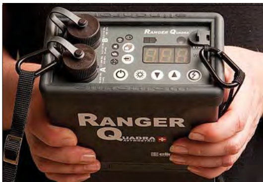
Рисунок 12.9 Ranger Quadra RX от Elinchrom является мини-вариантом распространенной модели Ranger. Его торoidalная импульсная трубка отправляет вспышку мощностью до 400 ватт. Два асимметричных силовых разъема питания обеспечивают до 100% мощности посредством одного выхода и до 33% посредством другого.
