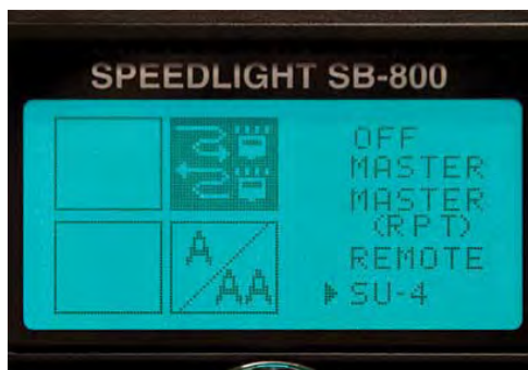
Рисунок 12.2 Вспышки SB-800 и SB-900 от Nikon могут быть запрограммированы для работы со вспышкой Canon – но только в ручном режиме. Встроенное оптическое ведомое устройство активируется переключением вспышки speedlight в режим SU-4.
