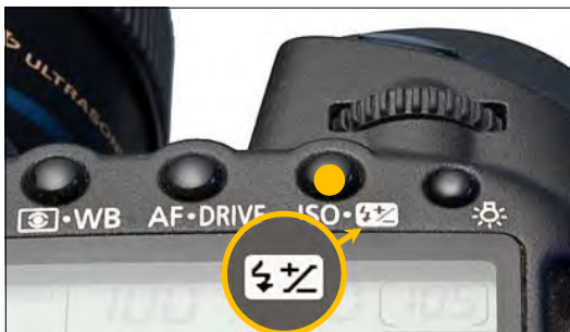
Рисунок 9.10 Можно изменить FEC, не отрывая глаз от видоискателя, нажав кнопку FEC и затем повернув диск быстрого выбора.
