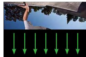
Рисунок 21.12 Когда спусковая кнопка нажата, полностью открывается 2-ая шторка, затем начинает открываться 1-ая шторка.
