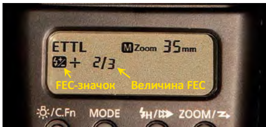
Рисунок 0.10 Установка FEC в 2/3 ступени на 480 EX II
