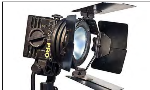
Рисунок 12.14 2.5-фунтовый Lowel Pro – кварцевый источник накаливания, который я приношу, когда должен залить светом большую площадь. Он зуммирует свет от широко и равномерно разлитого до прожекторного пятна. Шторки позволяют ограничивать то, куда должен падать свет.
