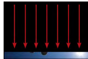
Рисунок 21.15 2-ая шторка продолжает свое движение в направлении поперек сенсора.
