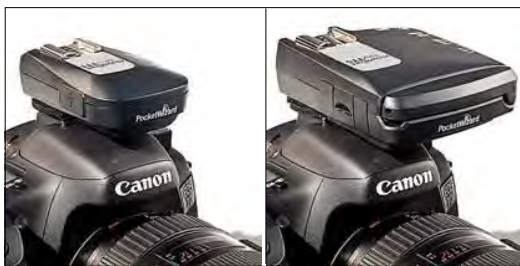
Рисунок 10.8 MiniTT1 (слева) PocketWizard u FlexTT5 (справа) от PocketWizard оба могут использоваться в качестве E-TTL радиопередатчика. FlexTT5 может также использоваться в качестве приемника.
