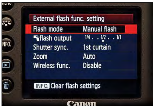
Рисунок 8.19 Экран ЖК-дисплея изменил свою конфигурацию. Обратите внимание, что над строкой "Shutter sync." (Синхронизации затвора) вставлена строка "Flash output" (Мощность вспышки). Это указывает на ручной режим установки уровня мощности вспышки Speedlite.
