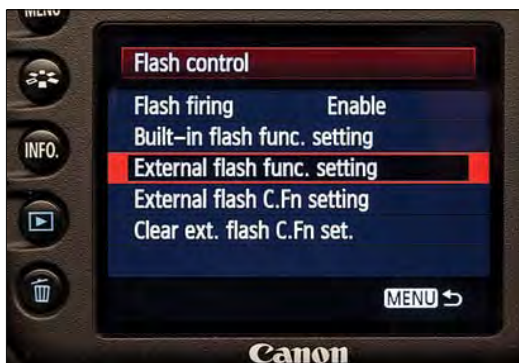
Рисунок 8.16 Нажмите кнопку Set (установки) в центре диска выбора, чтобы войти в подменю управления внешней вспышкой Speedlite.
