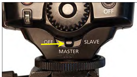
Рисунок 24.5 Внешний переключатель на 580EX является быстрым инструментом переключения с обычного в режим беспроводной вспышки.
