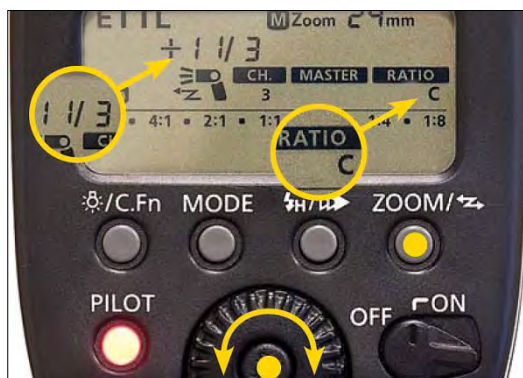
Рисунок 11.44 Шаг 5 – После того, как на вспышке Speedlite режим отношения устанавливается в A:B C , сначала выберите отношение A:B , как при работе с двумя группами. В установке FEC группы С ключевым является четырехкратное нажатие кнопки Sel/Set .
