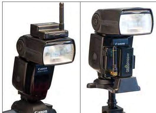
Рисунок 10.7 Я отдаю предпочтение E-TTL-радиосинхронизатору RadioPopper PX. Мне нравятся небольшой размер, легкость крепления на вспышке Speedlite и надежность. Слева показан передатчик, а справа – приемник.
