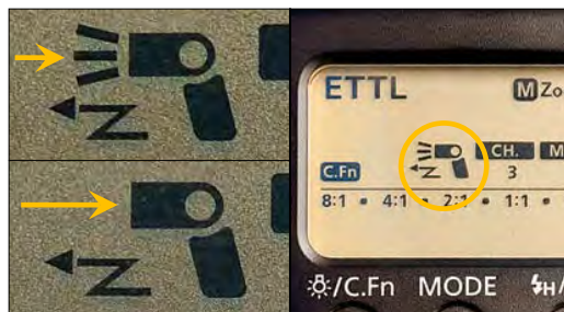
Рисунок 11.6 Лучи в верхнем левом кадре указывают, что срабатывание ведущей вспышки разрешено. Отсутствие лучей в нижнем левом кадре указывает, что ее срабатывание запрещено. Справа значок на ЖК-дисплее вспышки 580EX II.
