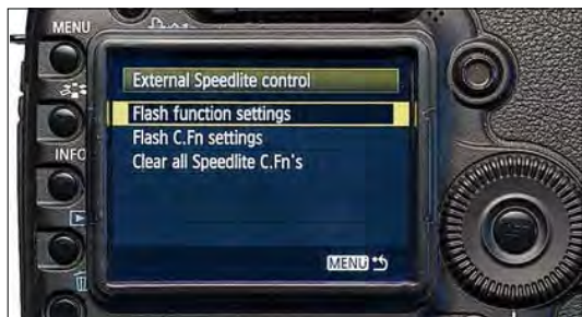
Рисунок 11.48 Шаг 2 – здесь показан экран меню External Speedlite control (Управление вспышками Speedlite) 5D Марк II. Экран вашей камеры может быть другим.
