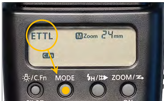
Рисунок 8.8 Если M не отображается вблизи верхней левой части ЖК-дисплея, нажимайте кнопку Mode (режим), чтобы циклически изменить режим с E-TTL до Manual (ручной). В ручном режиме сразу под M отобразится дробь. Эта дробь указывает на уровень мощности.
