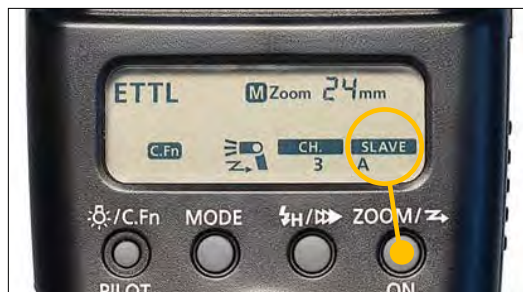
Рисунок 11.13 Чтобы переключить вспышку 430EX II в ведомый режим, удерживайте нажатой кнопку Zoom в течение 3".
