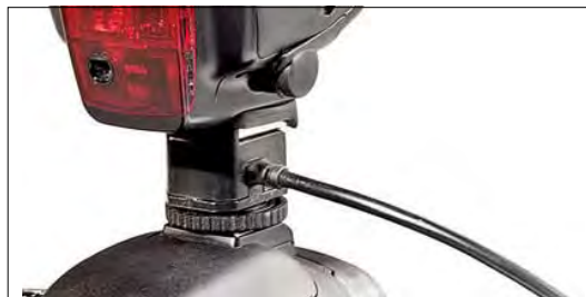
Рисунок 10.11 Крупный план адаптера горячего башмака камеры с установленной вспышкой Speedlite и кабелем, подсоединенным сбоку.
