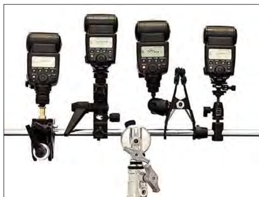
Рисунок 23.6 Рука штатива C-stand является великолепным местом для монтажа вспышек Speedlite. Слева направо: Super Clamp, настраиваемый пластмассовый адаптер зонта, Justin Clamp и мой самодельный держатель Lovegrove.
