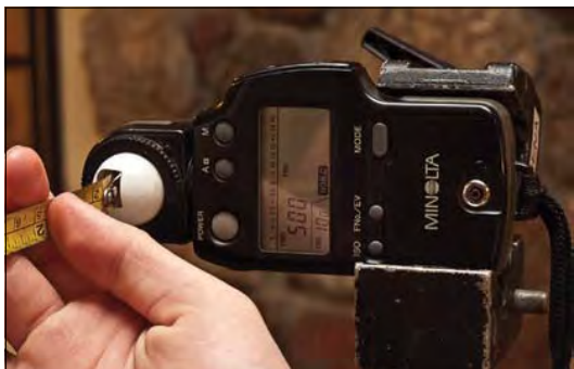
Рисунок 21.25 Мой старый испытанный Minolta Flashmeter IV вернулся с пенсии для количественной оценки импульсов мощности в режиме синхронизации вспышки при короткой выдержке.
