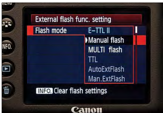
Рисунок 8.18 Вращайте диск выбора, так чтобы подсветить вход Manual flash (Ручная вспышка). Нажмите кнопку Set (установки) для подтверждения выбора.
