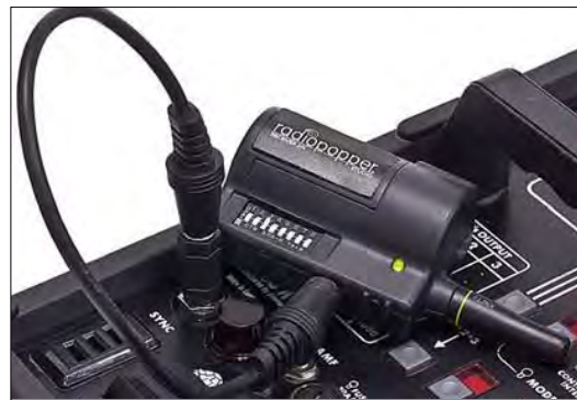
Рисунок 12.4 Приемники JrX от RadioPopper запускают срабатывание вспышек speedlight не-от-Canon, моноблоков и студийных пакетов точно в необходимый момент, при запуске передатчиком PX, который устанавливается сверху ведущей вспышки E-TTL.
