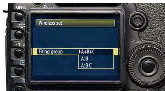
Рисунок 11.50 Шаг 10 – выберите A+B+C для одной группы, A:B для двух групп или A:B:C для трех групп.
