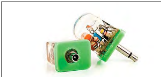
Рисунок 10.15 В конструкции ведомых устройств от Sonia, совместимых с Canon EX, имеется штырьковая часть разъема PC (слева) и miniphone (справа).
