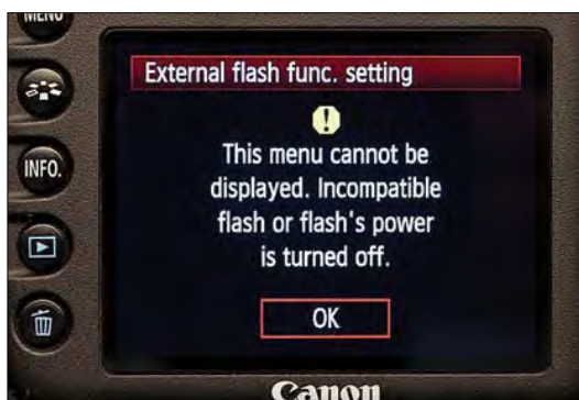
Рисунок 8.12 Подтверждение того, что камера и вспышка Speedlite связаны и что выключатель питания каждой включен. Если вы видите экран, показанный выше, перезагрузите вспышку Speedlite и переключите выключатель питания.
