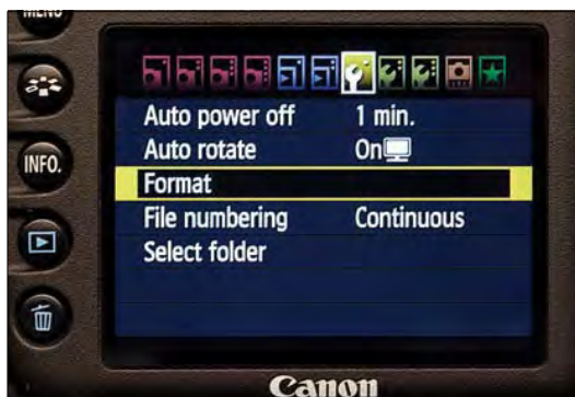
Рисунок 8.13 Нажмите кнопку Menu (меню) на камере (в верхнем левом углу). Отобразится последнее выбранное меню. Как показано здесь, на изображении дисплея камеры, последняя задача, которую я сделал через ЖК-дисплей, было форматирование карты CF.
