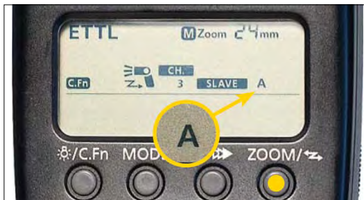
Рисунок 11.18 Нажатие кнопки Zoom циклически сменяет параметры беспроводного управления. Когда справа от метки Slave появится мигающая метка А, В или С, поверните диск выбора, чтобы выбрать канал, затем нажмите на кнопку Sel / Set, чтобы подтвердить ваш выбор.
